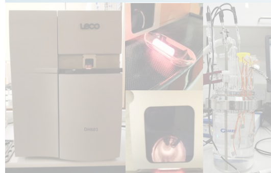
ENSAYOS EXSITU HIDRÓGENO ELECTROQUÍMICO
